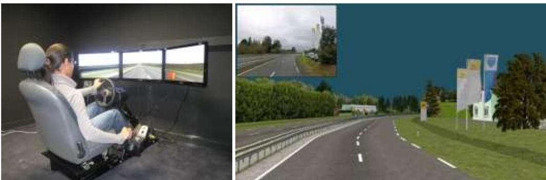
Figure 11. Simulateur de conduite Ifsttar déployé au Cerema pour les études de lisibilité de la route (à gauche) ; maquette virtuelle de la RD 786 utilisée pour étudier le comportement de conduite en zones de transition (à droite).
