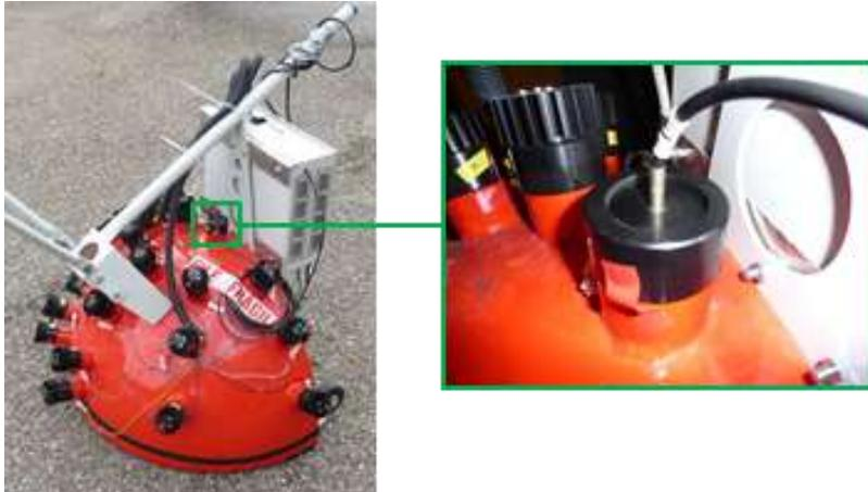
Figure 3. Prototype du goniorélectromètre transportable COLUROUTE2 (à gauche), permettant une mesure en observation zénithale (à droite).
