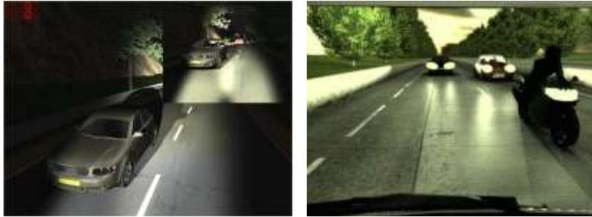
Figure 10. Images générées par des caméras embarquées en condition de nuit (à gauche) ou de jour (à droite), simulées avec la plateforme SIVIC.
