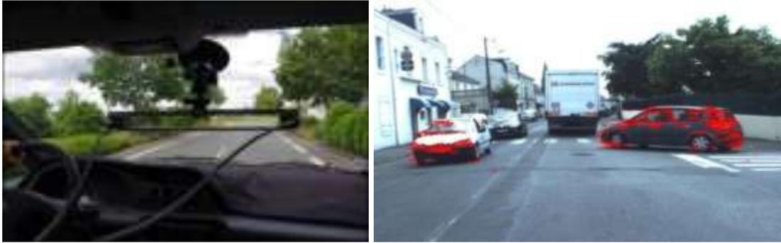
Figure 6. Paire de caméras calibrée géométriquement du système CYCLOPE<sup>2</sup> (à gauche), et résultat de segmentation des objets mobiles (en rouge) dans l'image de la scène routière (à droite).
