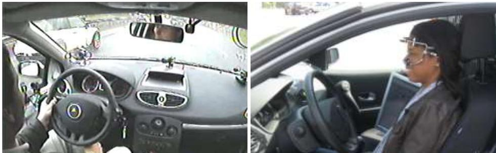
Figure 12. Le véhicule instrumenté dédié à l'étude des interactions du conducteur avec l'infrastructure et l'environnement routier (VOICIE) intègre un oculomètre déporté (à gauche), mais peut également exploiter l'oculomètre porté (à droite) utilisé sur simulateur de conduite.
