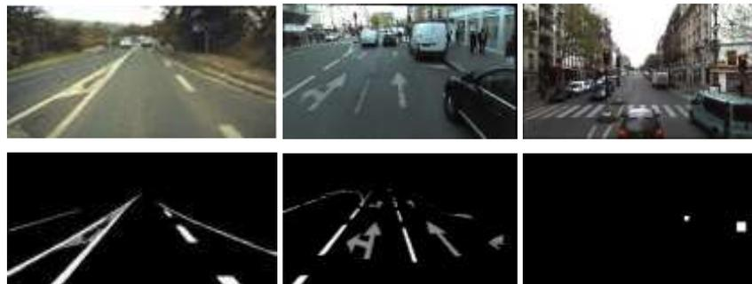
Figure 15. Extraits des vérités terrain produites pour évaluer les algorithmes de détection et de reconnaissance automatique des marquages (à gauche), notamment spéciaux (au centre) et des panneaux (à droite). A chaque image (en haut) est associé un masque (en bas) localisant et identifiant la signalisation.
